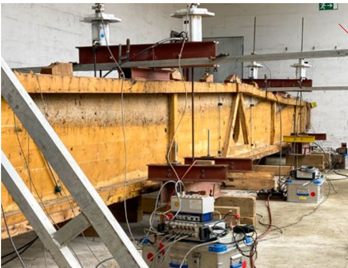
Auf dem Prüfstand: Wie viel Last wird der alte Holzbinder noch tragen? Der Versuch lieferte wertvolle Erkenntnisse.
